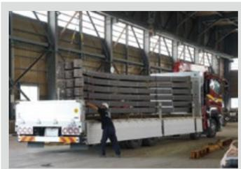
トンネル掘削の際に、孔壁が崩れないように支えるアーチ型のH型鋼です。トンネルの安全の要とも言える重要な部材です。これまでは熟練工の手作業で切断・曲げ加工・溶接していた作業を屋内工場での一貫した機械製造を実現しました。それにより、品質のばらつきを無くし、安定供給を可能にしました。新規施工のみならず、老朽化したトンネルの補修工事に最適な支保工製造と注入工事にも積極的に取り組みます。
